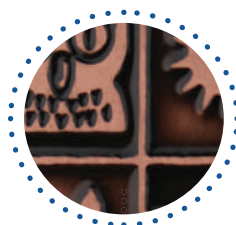
oksyda na podkładzie miedzianym
